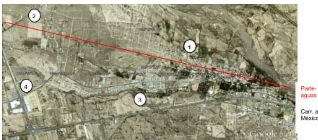
Figura 2.10. Parteaguas en la calle Hidalgo en el centro de Arteaga, que define el rumbo de las descargas de aguas residuales de la zona urbana
